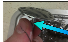
BEDEK HET DRAAD MET TAPE OM TE VOORKOMEN DAT DAAR EPOXY OP TERECHT KOMT
