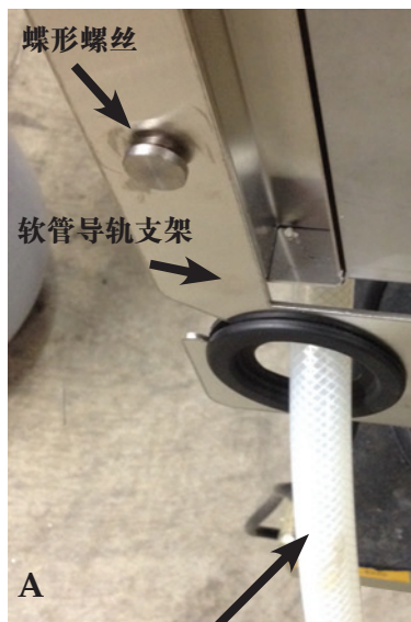
油脂收集软管
